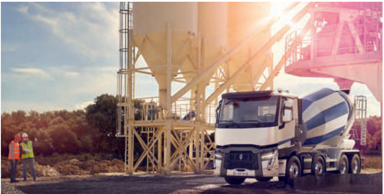
C XLOAD 8x4 betonvežio nuosavas svoris yra 9200 kg.
